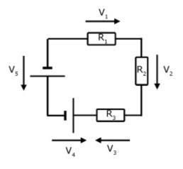
$V_1 + V_2 + V_3 - V_4 - V_5 = 0$
