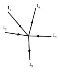
$I_1 + I_2 + I_3 = I_4 + I_5$  $I_1 + I_2 + I_3 - I_4 - I_5 = 0$
