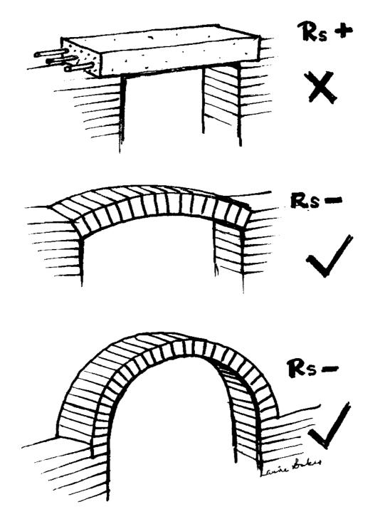
ईंट की मेहराबें, आर सी सी (RCC) के लिंटर जितनी ही मजबूत होती हैं, पर कहीं अधिक सस्ती होती हैं। यह मेहराबें देखने में बहुत सुंदर लगती हैं और उन्हें अनेक आकारों में बनाना संभव है। THE inexpensive way of spanning a hole in a wall is the simple "corbel" arch. Each row of bricks projects 2.25-inches beyond the course below until the bricks meet together in the middle. No fore work or shuttering is necessary.
