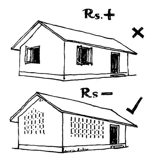
इन दोनों चित्रों में यह दिखाया गया है कि किस तरह खिड़िकयों की जगह ईंट की जाली ले सकती है। ऊपर वाले घर के मुकाबले में निचला घर बहुत अधिक सस्ता है। THERE are a number of building items, which are meant for a specific use but which we can also use to cut down costs.
