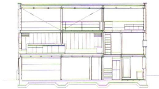
sección longitudinal por cocina / longitudinal section through kitchen
